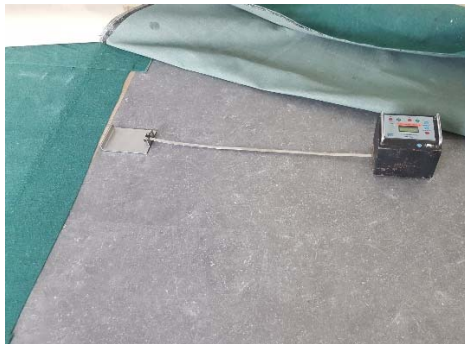
Bewertung des Gleitreibungskoeffizient [\mu] gemäß ÖNORM Z 1261
