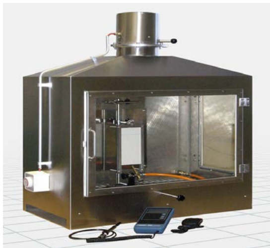
شکل 1. تجهیزات و شیوه آزمون استاندارد EN ISO 11925-2
