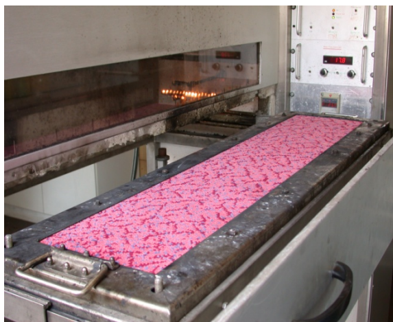
شکل 2. تجهیزات و شیوه آزمون استاندارد EN ISO 9239-1
